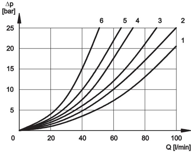
图中曲线5为差动阀芯S10、S20、S21、S22和S23的A和B油路间的压差曲线。
