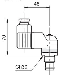
除了提供可视显示, 类似VPM型, 该指示器可以通过电气触点的切换来显示当前滤芯的污染是否已经达到极限状态。
