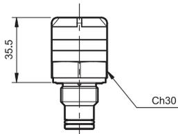
该指示器可以测量过滤器输入、输出之间的压差。
