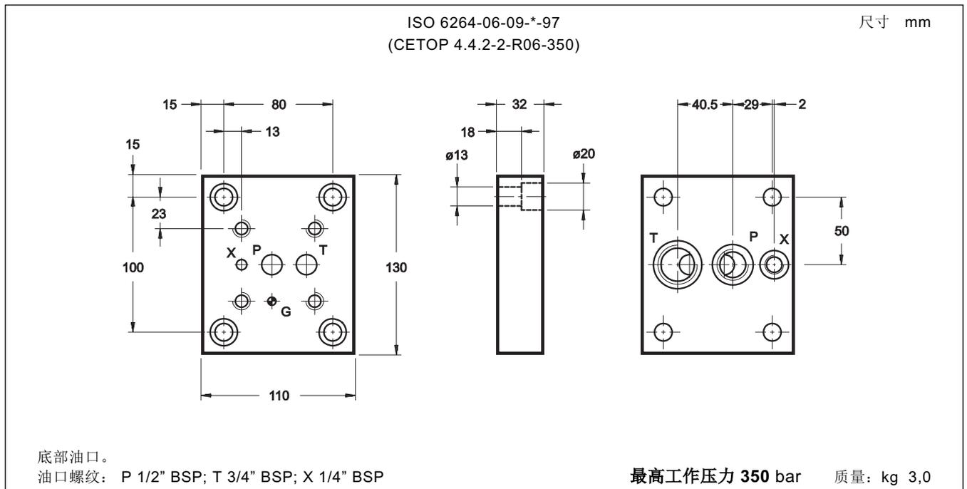
2 - PMRQ5-AI5G/20安装板外形和安装尺寸 (代码 1961221)
