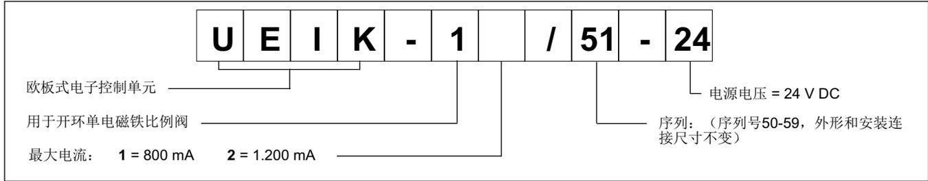
UEIK-1\* 型卡为欧板式电子控制单元, 用于开环单电磁铁比例阀。
