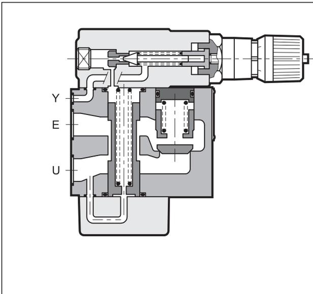
— 在液压系统中，当分支回路工作压力低于主回路压力时，系统采用Z\*-P型减压阀。
